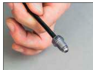
DIN flaring process
