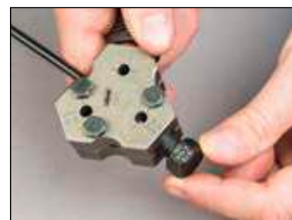
DIN flaring process
